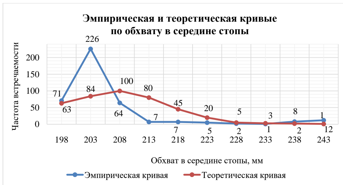
Рис.23. Эмпирическая и теоретическая кривые по обхвату в середине стопы для женщин (левая стопа)
